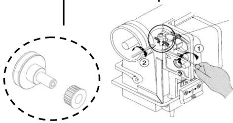
時規皮帶鬆緊固定螺絲，可依所需調整皮帶鬆緊
