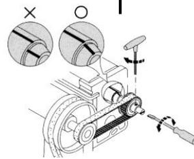
變速機的紅線對齊入立軸紅線後，上緊時規齒輪螺絲
